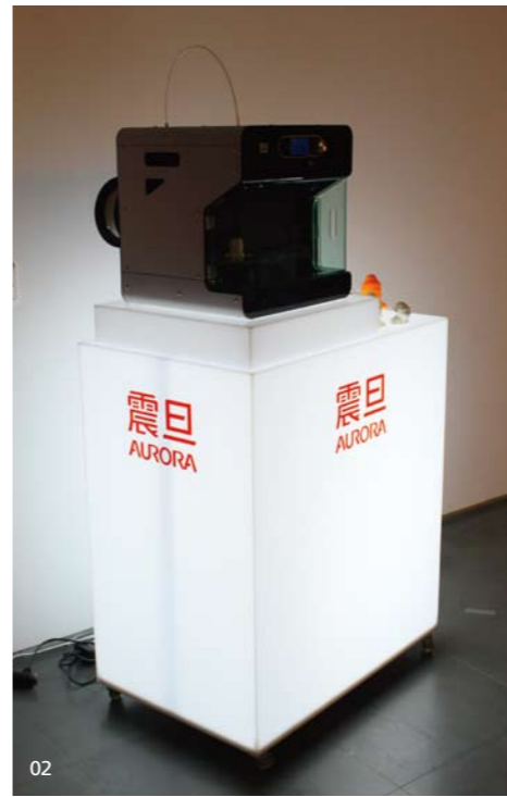
02_震旦3D印表機使用熱熔堆疊成型技術以及環保耗材PLA線材，並具有圖形化液晶面板、中文化人機介面。03_研討會現場各貴賓提出精闢見解，與在場聽眾分享3D列印趨勢與未來。左起：工研院南分院林得耀副理、達梭系統許欲生經理震旦集團3D支援部蔡坤明資深總監。04_3D列印議題吸引現場近百位包含設計、電子、教育、娛樂等產業人員踴躍參與。
