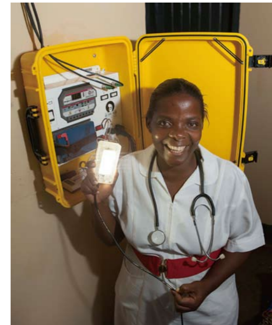
可裝在行李箱的太陽能發電系統，整合有太陽能發電板、充電池、充電控制器、LED燈，可以直流電迅速支援產前心臟監測器等醫療器材使用，意在提供簡易而易於取得的電力，並於夜間提高婦女生產的安全性。
