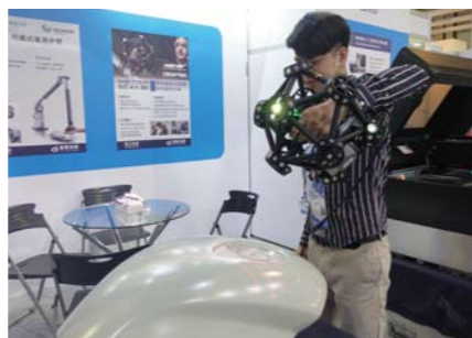
現場工程師用Metra Scan直接掃描重機亮面油箱，快速獲取3D網格資料
