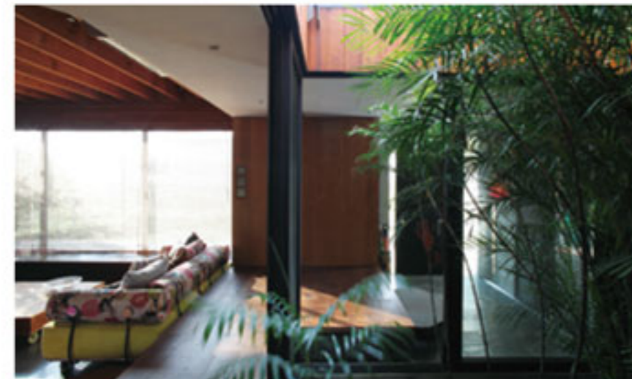
一樓高度原以8尺合板長度最為經濟，但會讓天花板產生壓迫感，因此簡祺坤讓客廳採取下凹式的半開放設計，產生更開敞的高度。
