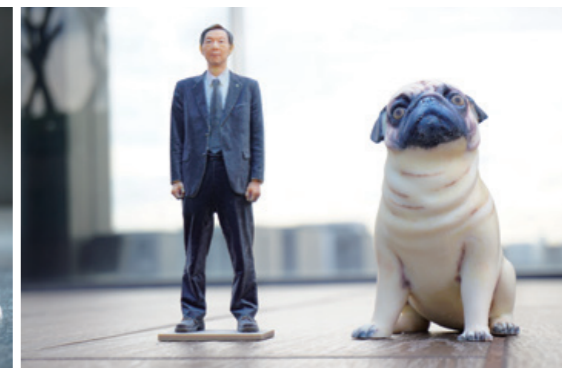
使用3D掃描器擷取人像或寵物的3D資料，透過Stratasys J750全彩3D列印機台，高解析度加上滿足Pantone的色彩品質和實現驗證標準，所製作出的3D公仔刺激消費者的視覺神經，引起市場熱議討論。
