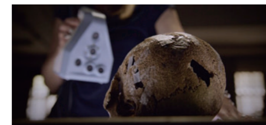
2016年中國西安西北大學研究人員使用Artec Spider掃描器3D解析度及精度分別高達0.1mm至0.05mm。
