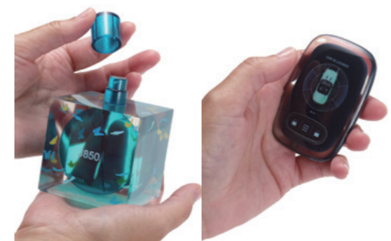
▲利用Stratasys J850全彩3D列印機的VeroUltraClear全新透明材料，搭配Pantone顏色製作出極高精度、細緻紋理以及出色的圖像和顏色品質來完成超逼真的香水瓶及車鑰匙模型。
