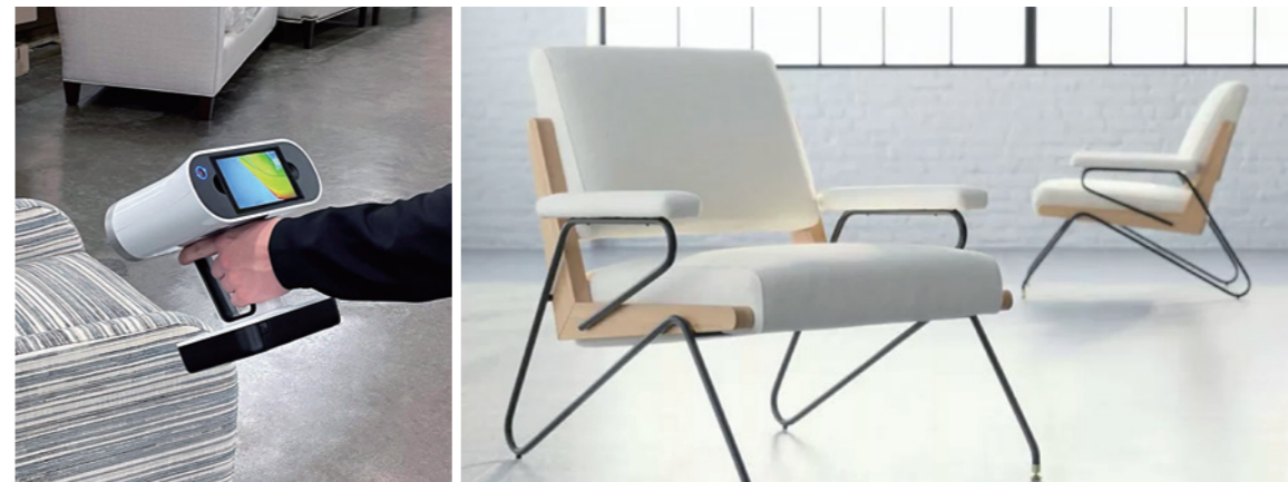
圖左：透過Artec Leo無線手持3D掃描器快速掃描椅子。圖右：3D掃描的Sherrill Furniture訂製座椅，置於CGI渲染的房屋內，可供銷售團隊快速製作產品型錄。
