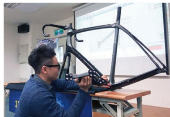
工程師展示MetraSCAN 3D掃描器並同時呈現掃描結果，再搭配HandyPROBE做定位點量測
