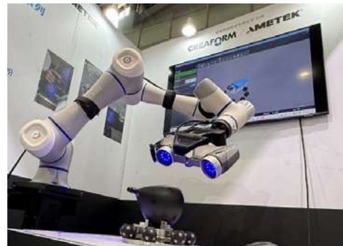
左：Stratasys F3300機型以高精度、速度與穩定性領先，支援多種工程材料，滿足電子業需求。右：通業技研將Creaform手持雷射3D掃描結合協作型機械手臂打造全自動快速檢測。
